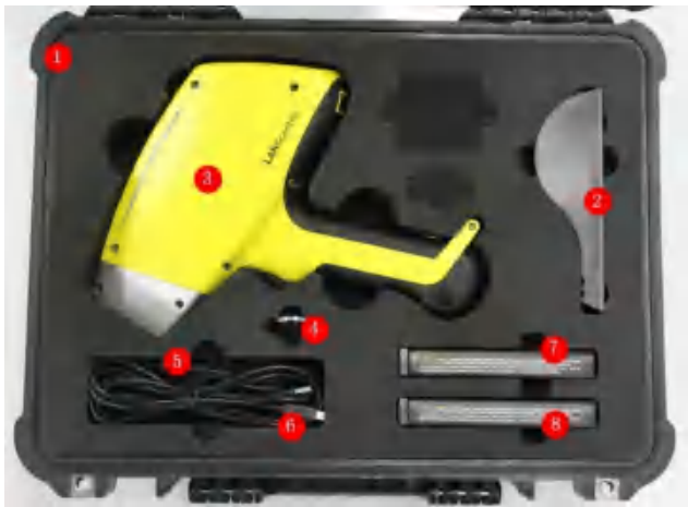
Truex 手持式 X 射线荧光分析仪
