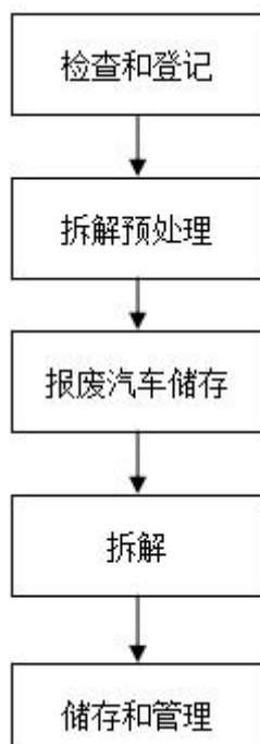
图 4.3-1 报废汽车拆解作业流程图
