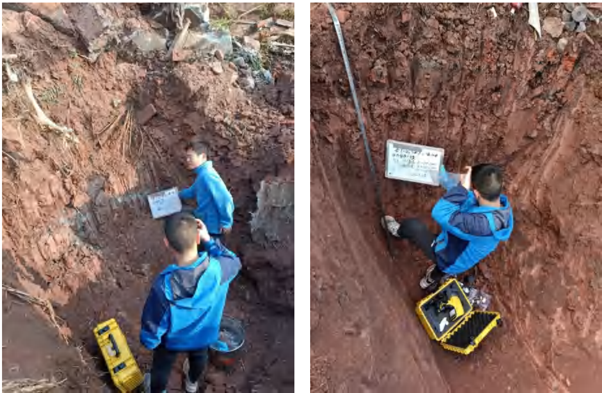
S2（0-1.5m 回填土、1.5-1.8m 粉质黏土、1.8m 以下粉砂质泥岩，挖掘深度 2m） S3（0-0.3m 回填土、0.3-1.8m 粉质黏土、1.8m 以下粉砂质泥岩，挖掘深度 1.9m）
